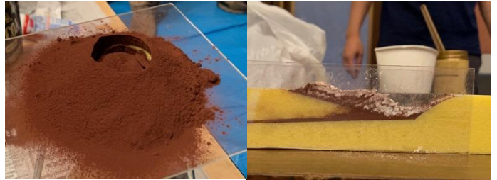
【写真3: ココアパウダーを利用したカルデラと付加体の再現実験】
