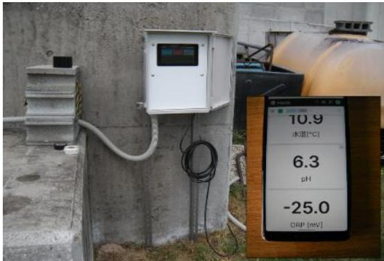
写真1. 試作機と水質データの表示画面
