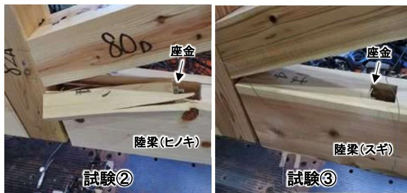
写真1 試験後の破壊状況(トラス中央部)
