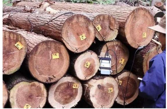
図2 はい積み丸太の乾燥の計測
