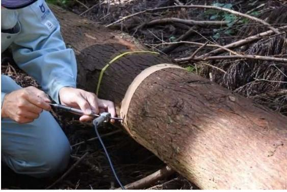
図1 葉枯らし中のスギの乾燥の計測
