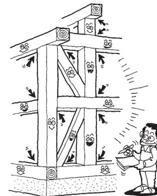
耐力壁・準耐力壁等が取り付けられている柱の柱頭・柱脚は、発生する応力に耐えられる接合方法とします。
