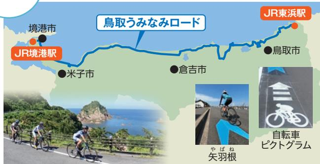
県内を東西に結ぶサイクリングルート「鳥取うみなみロード」に矢羽根等の設置を進めています。自転車利用者とドライバーの双方が安心、安全に走行できる環境づくりを推進していきます。
