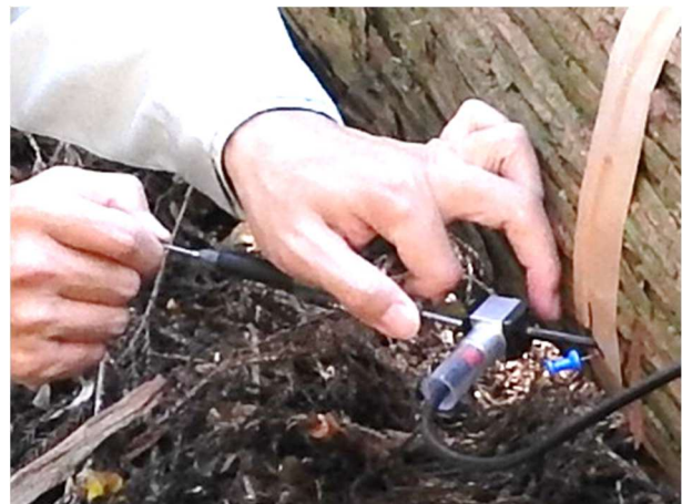
写真2 定力打撃装置でのセンサーへの加力
