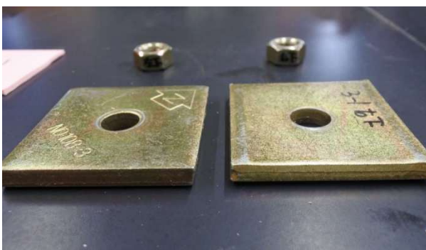
写真7 Z角座金 W9.0x80(試験後)
