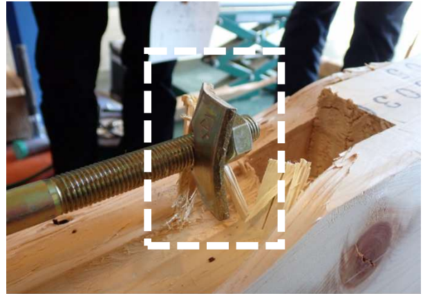
写真1 既報における座金の変形
