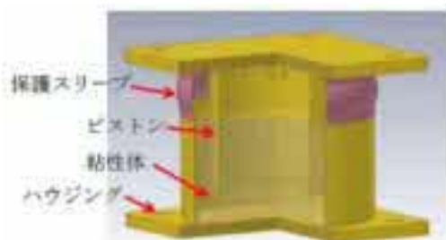
水平2方向と鉛直方向のゆれを同時に吸収する制震装置(三軸粘性ダンパ)
