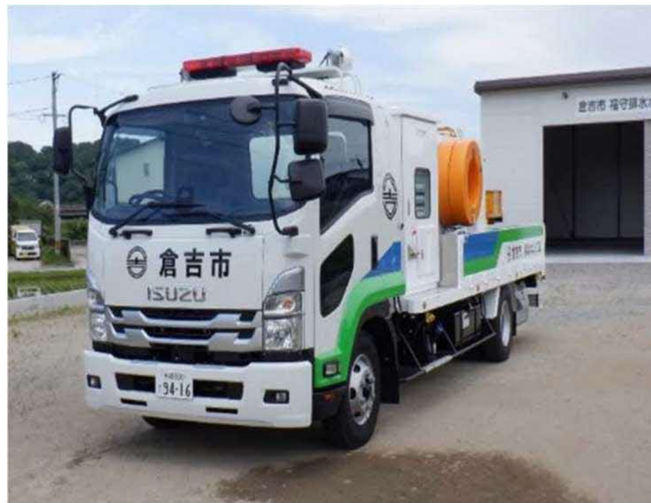
配備した排水ポンプ車(排水能力：30m 3 /分)
