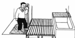
浴室やトイレをとりの部屋と同じ高さにするには、すのこが便利。すき間がないように敷きつめる。
