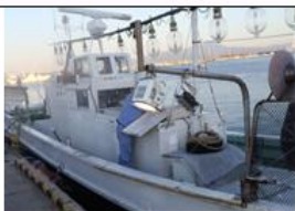
小型船によるLED集魚灯の設置例
