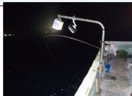
小型船によるLED集魚灯の設置例
