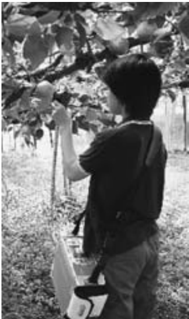
第2-18図 試験に用いた携帯型非破壊糖度センサー（クボタ社：K-BA100） 調査時は黒色布で果実とプロープを覆って外光の進入を遮断した（右）
