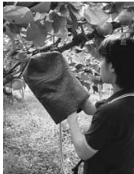
第2-18図 試験に用いた携帯型非破壊糖度センサー（クボタ社：K-BA100） 調査時は黒色布で果実とプロープを覆って外光の進入を遮断した（右）
