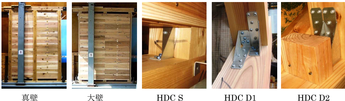
図-1 供試体外観と柱脚の接合方法
