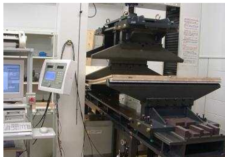
図2 クロスパネルの曲げ試験
