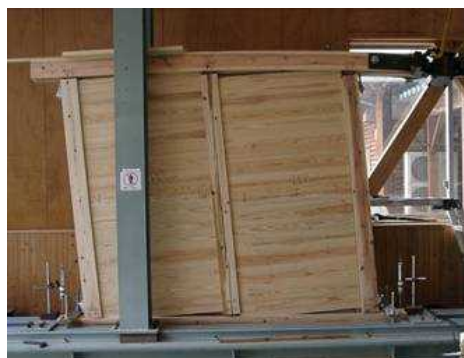
図3 落とし込み壁の耐力試験
