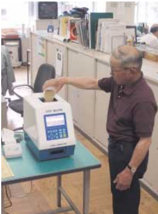
運転で食味値を計る越峠さん (日野特別栽培米研究会会長) 平成21年6月9日
