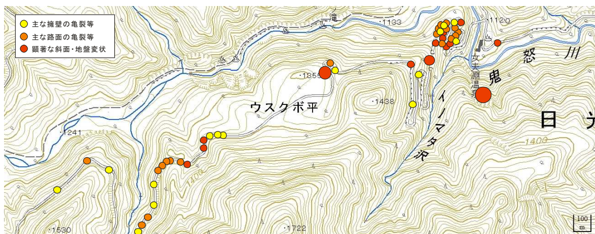
図 1.2-5 2013年2月25日栃木県北部を震源とする地震による主な斜面・地盤変状の分布(若井(2013)) 5
